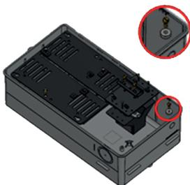
O sistema de aterramento é feito através da caixa. Na caixa é utilizado o parafuso M6x16mm e duas arruelas fixado ao alojamento.
