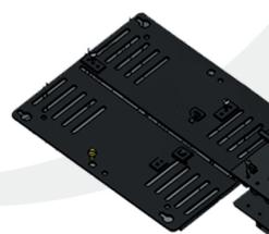
Para fixar o medidor, primeiro prenda a placa na caixa do medidor utilizando dois parafusos M6 X 10mm. Em seguida, encaixe as presilhas de fixação do medidor na placa, alinhando-as com as furações do medidor. Então, posicione o medidor e fixe-o utilizando três parafusos de 4,2x16mm.
