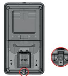
Para o fechamento da caixa, encaixe a tampa no corpo e fixe utilizando o parafuso lacre fornecido pela ENEL, conforme indicado na imagem ao lado.
